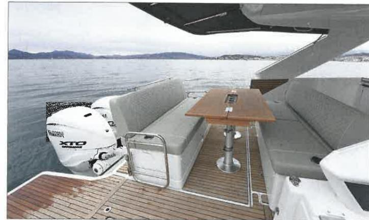
La disposition du cockpit est identique à celle de la version in-bord et propose de multiples configurations grâce à une banquette avant montée sur glissière et à une table qui n'est malheureusement disponible qu'en option. Ces aménagements permettent d'obtenir un carré en face-à-face, un grand bain de soleil ou deux banquettes orientées dans le sens de la route.
