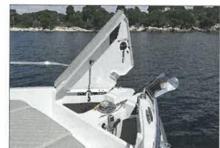
La baïlle à mouillage est profonde et équipée d'un guindeau électrique.
