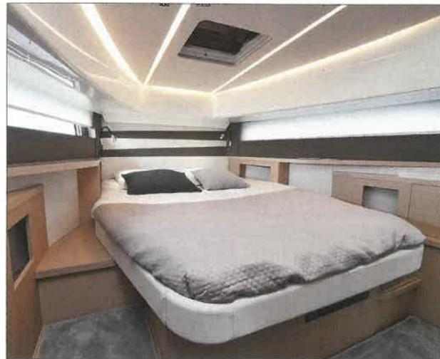
La cabine avant, d'une hauteur sous barrots de 1,90 mètre, reçoit un lit double de 2 x 1,52 mètre, des équipets et une penderie pour le rangement.
