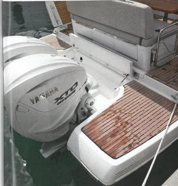
La circulation entre les deux plateformes se fait grâce à une petite planche qui recouvre la cuvette moteur et qui se relève quand les blocs doivent être remontés.
