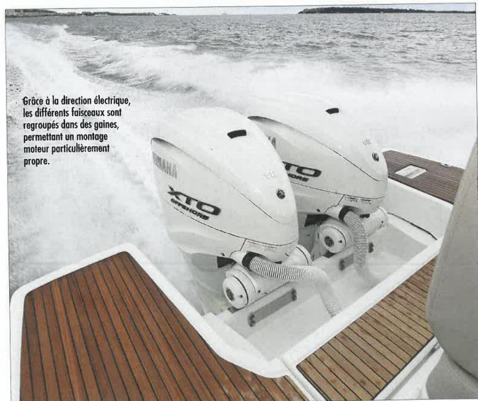
Grâce à la direction électrique, les différents faisceaux sont regroupés dans des gaines, permettant un montage moteur particulièrement propre.
